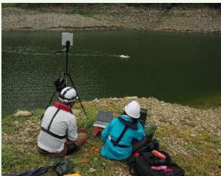
設定測線の自律航行による測量状況
