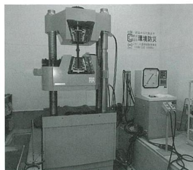
環境防災に導入した材料試験用の万能試験機
